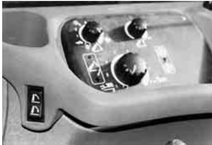
Fig. 8.17 De werkschakelaar van de elektronische hefinrichting, links onder op de foto, is gemakkelijk te bedienen.
