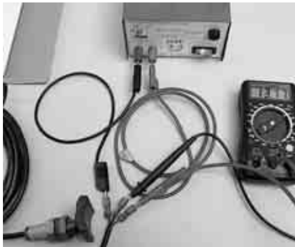
Fig. 8.3 Het doormeten van een inductieve benaderingssensor
