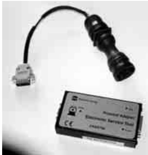
Fig. 8.11 Via de CAN-Busaansluiting kun je met deze adapter en een pc storingen bij een machine opsporen.
