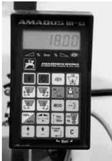
Fig. 8.7 Bij deze monitor met toetsenbord is er voor iedere functie een bedieningsknop.
