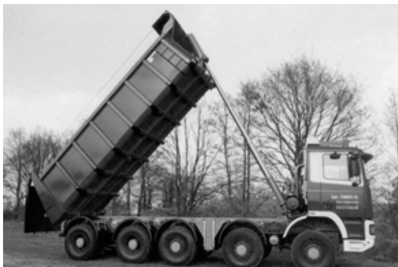
Fig. 2.25 Bij vrachtwagens zit de telescoopcilinder aan de voorkant.
